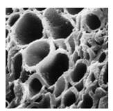
Il existe deux procédés distincts d'adsorption par le charbon actif : l'un utilise le charbon actif en poudre (CAP), l'autre le charbon actif en grains (CAG). Tous les deux reposent sur l'accumulation, à la surface et à l'intérieur du charbon, des matières organiques contenues dans l'eau, par interactions chimiques et physiques. Chacun est utilisé dans des conditions bien spécifiques.
